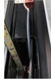
5. Den neuen LED-Streifen in eine Alu-Führung einschieben und den elektrischen Steckverbinder wieder einstecken. Das Schutzband wieder anlegen und sicherstellen, dass die Zugangsöffnung dicht ist. Die Abdeckleiste anlegen.
