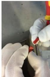
3. LED-Streifen herausziehen, durch einen neuen ersetzen und den elektrischen Steckverbinder wieder einstecken.
