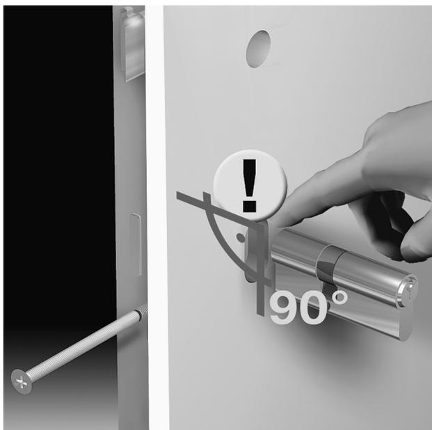
Zylinder spannungsfrei einbauen bzw. 90 Grad hin zum Türflügel ausrichten.
