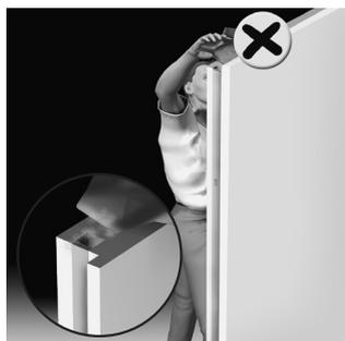
Diverse Verunreinigungen im oberen Bereich des Türblattes (z. B. Putzreste) dürfen nicht in Richtung Schloss (Stulp) gewischt werden – Verunreinigungen können hinter dem Schlossstulp gelangen und anschließend die Verriegelung blockieren.
