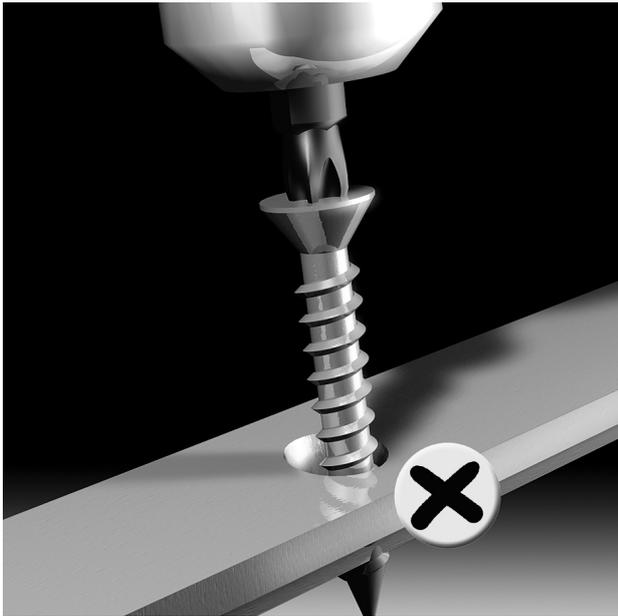
Schrauben gerade eindrehen, damit keine Verspannung auftreten kann.
